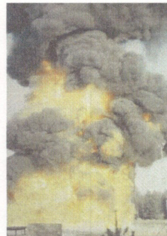
Kohärente Strukturen in einer n-Pentan Poolflamme (d = 25 m)
