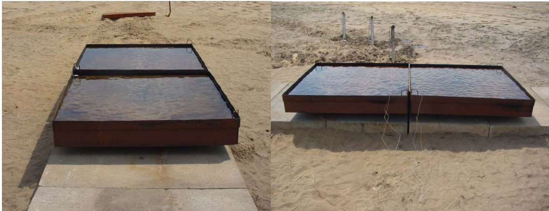
Abb. 2 Aufbau der Abbrandwannen ( d = 1.5 \text{ m} ) mit D/d = 0
